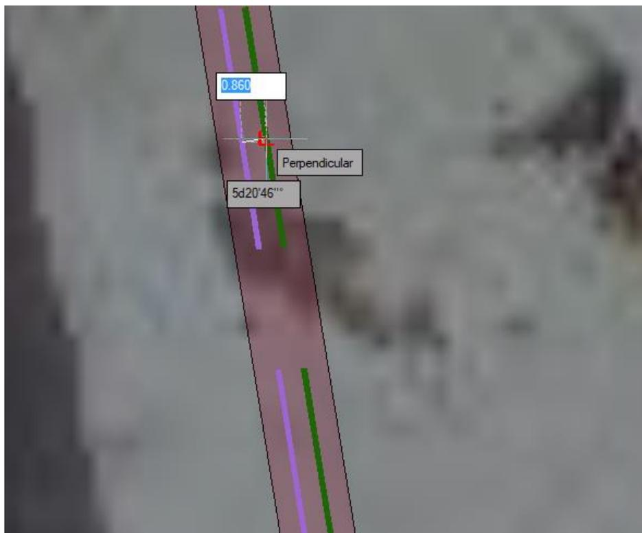
Nesse caso, Lf é variável. A área foi obtida, então, multiplicando o valor de Lf pelo comprimento Len. Contudo, como Lf é variável, o comando “AA” no autocad é capaz de gerar uma área consideravelmente mais precisa, equivalente a **1.005,78 m<sup>2</sup>**.
