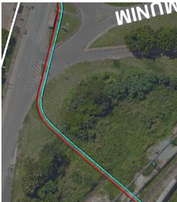
O trecho 01 possui uma linha com dois dutos. Nesse caso, a área foi obtida, então, multiplicando o valor de  $L_f$  pelo comprimento  $Len$ . Contudo, como  $L_f$  é variável, o comando “AA” no autocad é capaz de gerar uma área consideravelmente mais precisa, equivalente a **3.912,54 m<sup>2</sup>**.
