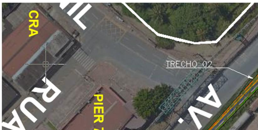
O trecho 02 possui uma linha com vários dutos. Nesse caso, a área foi obtida, então, multiplicando o valor de  $L_t$  pelo comprimento  $Len$ . Contudo, como  $L_t$  é variável, o comando “AA” no autocad é capaz de gerar uma área consideravelmente mais precisa, equivalente a **2.393,40 m<sup>2</sup>**.
